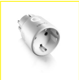
Enchufe IO ON/OFF Control a distancia IO con retorno de información Frecuencia radio: 868 Tri Band Mhz Alcance interior : 8 metros Alcance en campo abierto: 200 metros Índice de protección: IP 20 1822618
